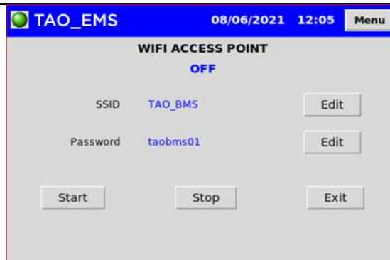
Sélectionnez *Menu -> Wi-Fi -> Access point* pour ouvrir la configuration et l'activation du « Point d'accès ».
